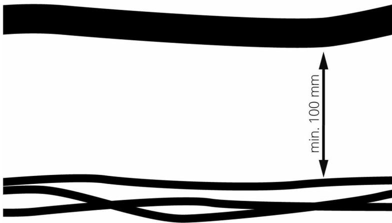
Abb. 7: Mindestabstand Motor-/Sensorkabel
