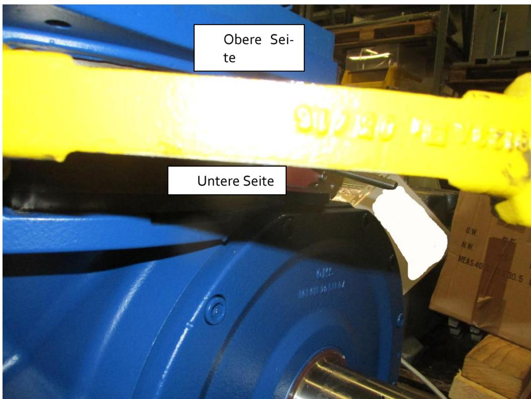
Bremsschuh 1 auf den Bremsarm schieben, Stufenbohrung ist oben, Gewinde ist unten. Aufpassen und die O-Ringe nicht beschädigen!
