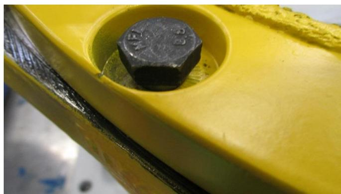
Kopf der Schraube 3 darf den Bremsschuh 1 nicht berühren
