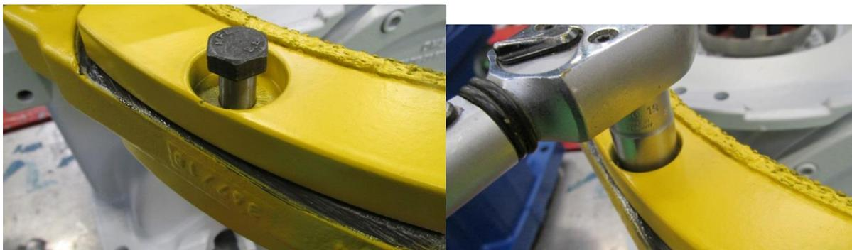
Schraube mit  $T = 30\text{Nm}$  festziehen..
