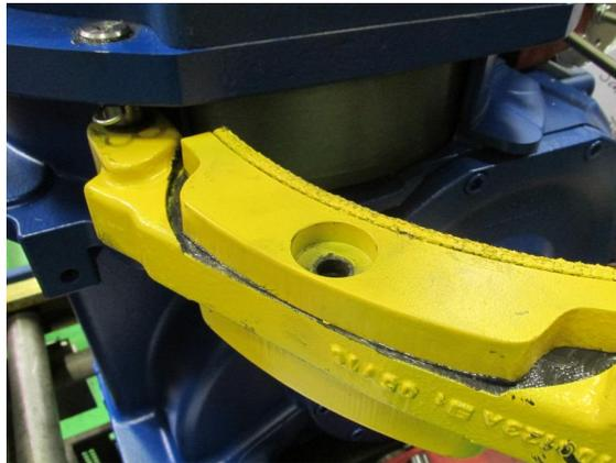
Schraube 3 in die Bohrung des Bremsschuhs einführen.
