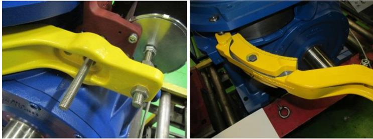
Schraube lösen und zusammen mit Scheibe entfernen.
