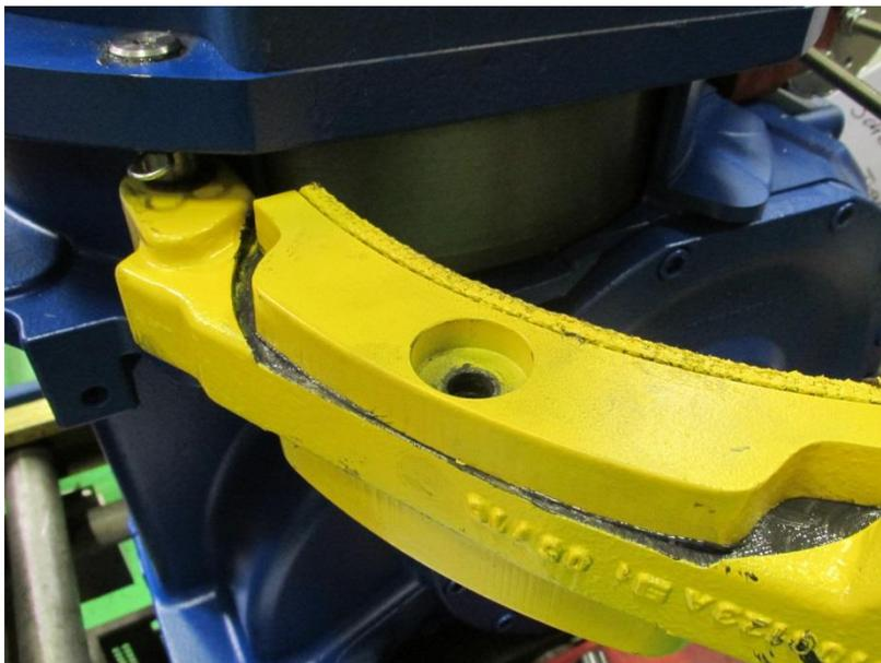
Entferne die Bremsbacke 1 und die O-Ringe 2 (oben und unten).
